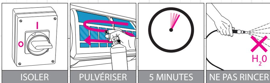
Isoler les circuits électriques. Pulvériser le produit à l'intérieur du serpentin, en commençant par le haut et puis en allant de droite à gauche et petit à petit vers le bas. Laisser agir pendant 5 minutes. Il est inutile de rincer.
