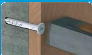
2. Nettoyez soigneusement le trou et insérez le clou-vis prémonté dans le trou.
