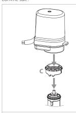
nstaller la bague dentée (C) sur le raccord de la vanne et/ou collecteur standard Giacomini, en la poussant vers le bas. Accrocher ensuite la tête électrothermique à la bague.
