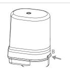
Au terme de l'installation, pousser manuellement le levier (B) à l'intérieur de la tête.
