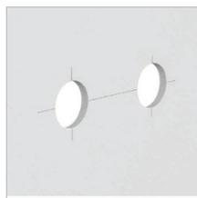
Percer deux trous de 63 mm de diamètre dans la cloison de plâtre à l'aide d'une scie cloche.
