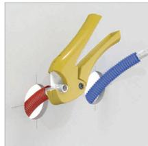
Sortir les tubes Multicouche et ajuster leur longueur à l'aide d'une pince coupe-tube de façon à pouvoir utiliser la pince à sertir.
