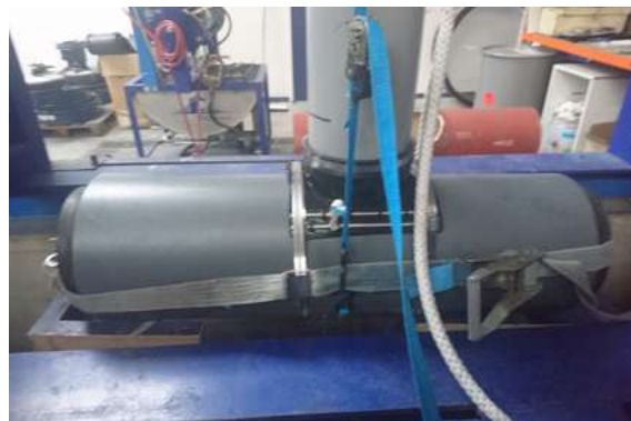
Tests d'étanchéité et de tenue à la pression sur le banc d'essai de NORHAM.
