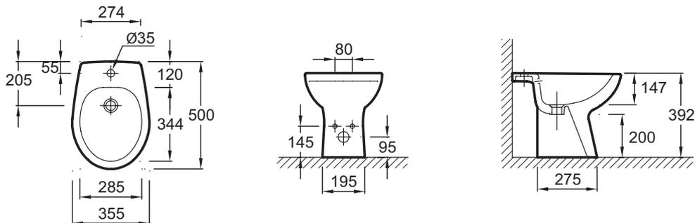
Descriptif CCTP : Bidet au sol. E4382. Collection : BRIVE. DIMENSIONS : 50 x 35,50 cm. POIDS : 13,5 kg. MATÉRIAU : Céramique. TYPE D'INSTALLATION : Au sol. HAUTEUR : Standard. PRODUIT INCLUS : (robinetterie non incluse). Percé 1 trou.
