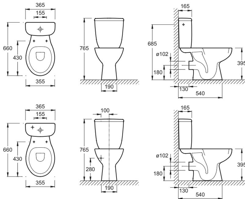
Descriptif CCTP : Cuvette, sortie horizontale. E4380. Collection : BRIVE. DIMENSIONS : 66 x 35,50 cm. POIDS : 15,6 kg. MATÉRIAU : Céramique. TYPE D'INSTALLATION : Au sol. CONSOMMATION D'EAU : Standard 3/6 L. HAUTEUR : Standard. PRODUIT INCLUS : (réservoir et abattant non inclus). Fonctionnement double chasse 3/6 L. Sortie horizontale.
