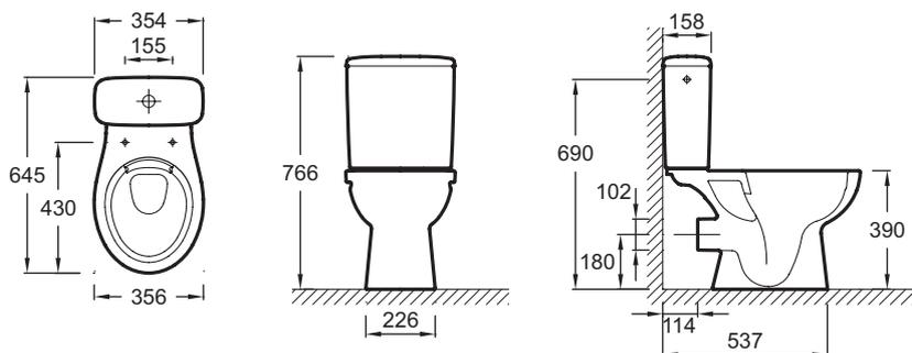
Descriptif CCTP : Pack cuvette SANS BRIDE sortie horizontale. E22918. Collection : PATIO. DIMENSIONS : 78,70 x 38,50 cm. POIDS : 36,6 kg. MATÉRIAU : Céramique. TYPE D'INSTALLATION : Au sol. CONSOMMATION D'EAU : Standard 3/6 L. HAUTEUR : Standard. TYPE DE BRIDE : Sans bride.
