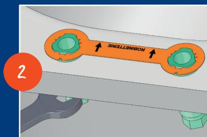
**Glisser les embases de colonnette dans les trous.** Installer le gabarit de forme garantissant l'entraxe 150 mm et permettant de régler l'alignement par rapport au rebord de la baignoire. **Immobiliser les embases en serrant les écrous.** Ôter le gabarit.
