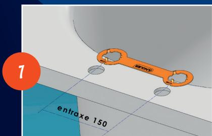
**Utiliser le gabarit de pose fourni** pour positionner l'emplacement des 2 trous à entraxe 150 mm.
