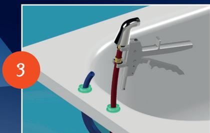
**Sortir les tubes.** Raccorder les colonnettes aux tubes selon le type de raccord choisi. (exemple d'un raccord à glissement sur tube PER).
