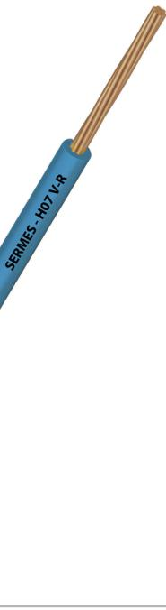
**CARACTÉRISTIQUES DÉTAILLÉES**Code article **11127114**Âme **cuivre nu câblé, classe 2**Isolation **PVC**Tension de service **450 / 750 V AC**
