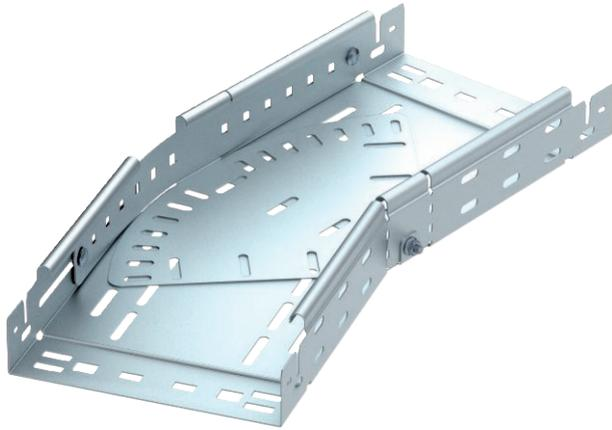
Coude variable de 0° à 90° avec système de fixation rapide. Pour tous types de chemins de câbles d'une hauteur latérale de 60 mm.
